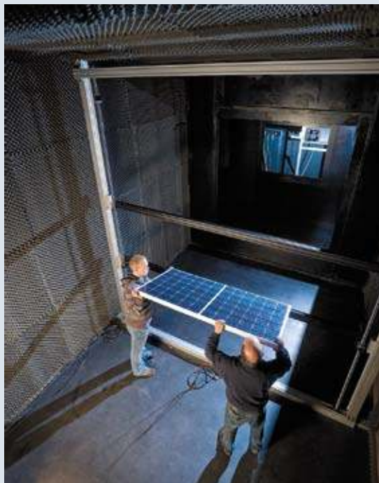
Große Blackbox: Der Sonnensimulator im PHOTON-Labor ist – logischerweise – in einer hermetisch lichtdichten Kammer untergebracht
