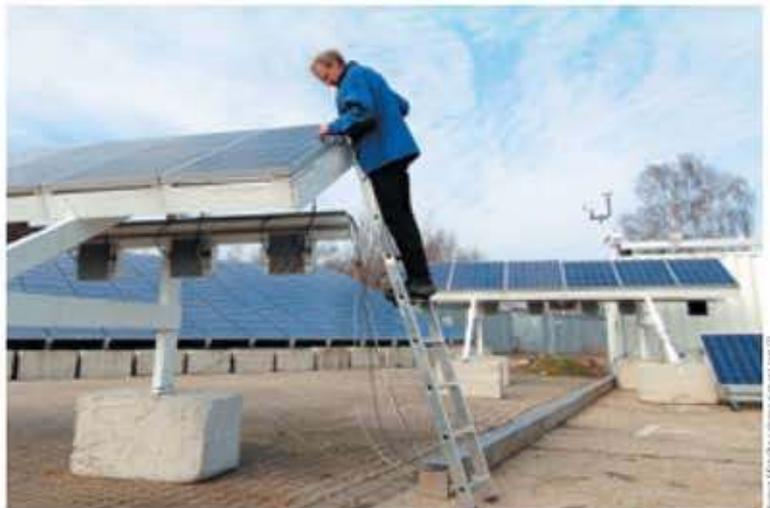
Messungen im PHOTON-Labor: Die STC-Leistung eines Moduls ermittelt der Flasher in Sekundenbruchteilen. Die Ermittlung des Ertrags dauert etwas länger – nämlich ein Jahr auf dem Freifeldteststand.
