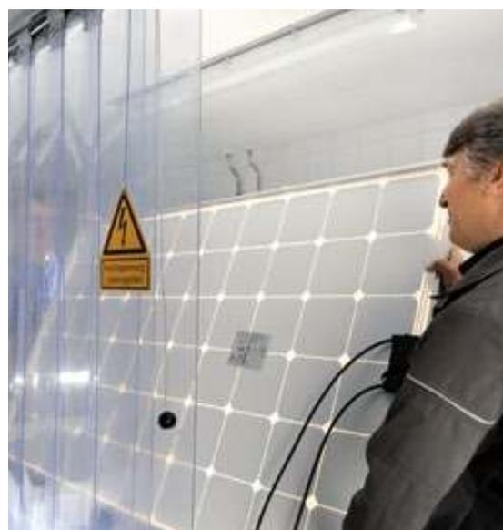
☀ Teilentladungsprüfung | Elektrischer Isolationstest
